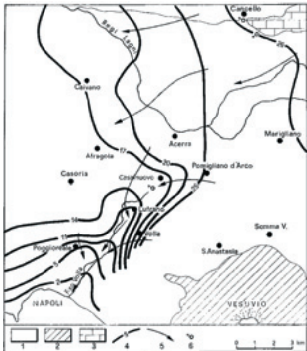
Figura 4 – Carta a curve isopiezometriche della piana del Volla e dell'alto corso dei Regi Lagni (Civita et alii, 1973, integrata). Legenda: 1) Depositi piroclastico-alluvionali; 2) Depositi piroclastici e lave; 3) Rocce carbonatiche; 4) Curve isopiezometriche e relativa quota in m s.l.m.; 5) Direttrici di flusso idrico sotterraneo; 6) Sorgenti principali.
