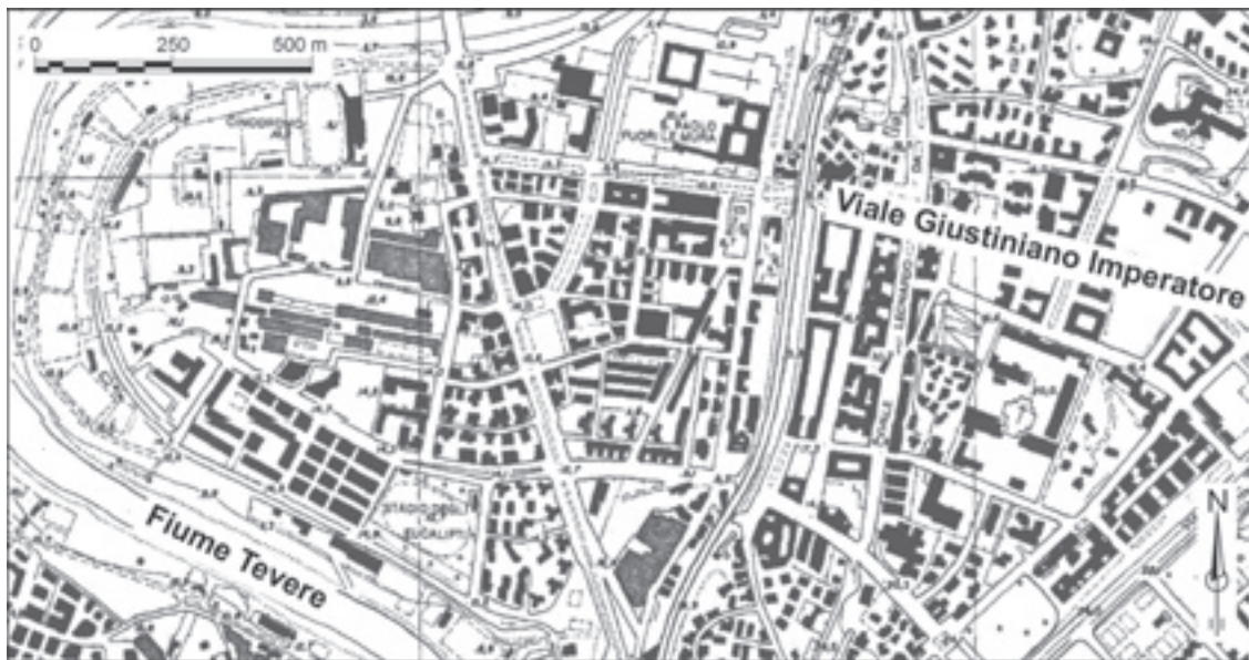
Figura 15. Settore dell'XI Municipio della Città di Roma con fenomeni di dissesto per presenza di terreni non consolidati. Figure 15. Sector of the 11 th Sub-Municipality of Rome with instability phenomena due to unconsolidated soils.
