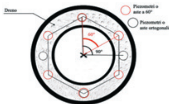
Figura 9. Schema in pianta dei fori per cementazione dall'esterno del pozzo: l'iniezione della boiaccia (in pressione) avviene per mezzo di tubi inseriti in ognuno dei fori.
