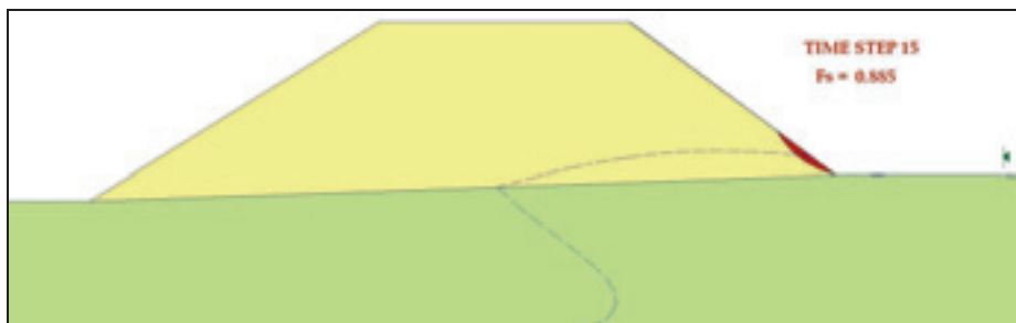
Figura 9: Analisi di stabilità degli argini in località Restone. Visualizzazione della sezione arginale in cui nella modellizzazione si verifica la condizione più critica: il settore che nella simulazione si distacca per scivolamento rotazionale è colorato in rosso, la linea azzurra rappresenta la superficie freatica.
