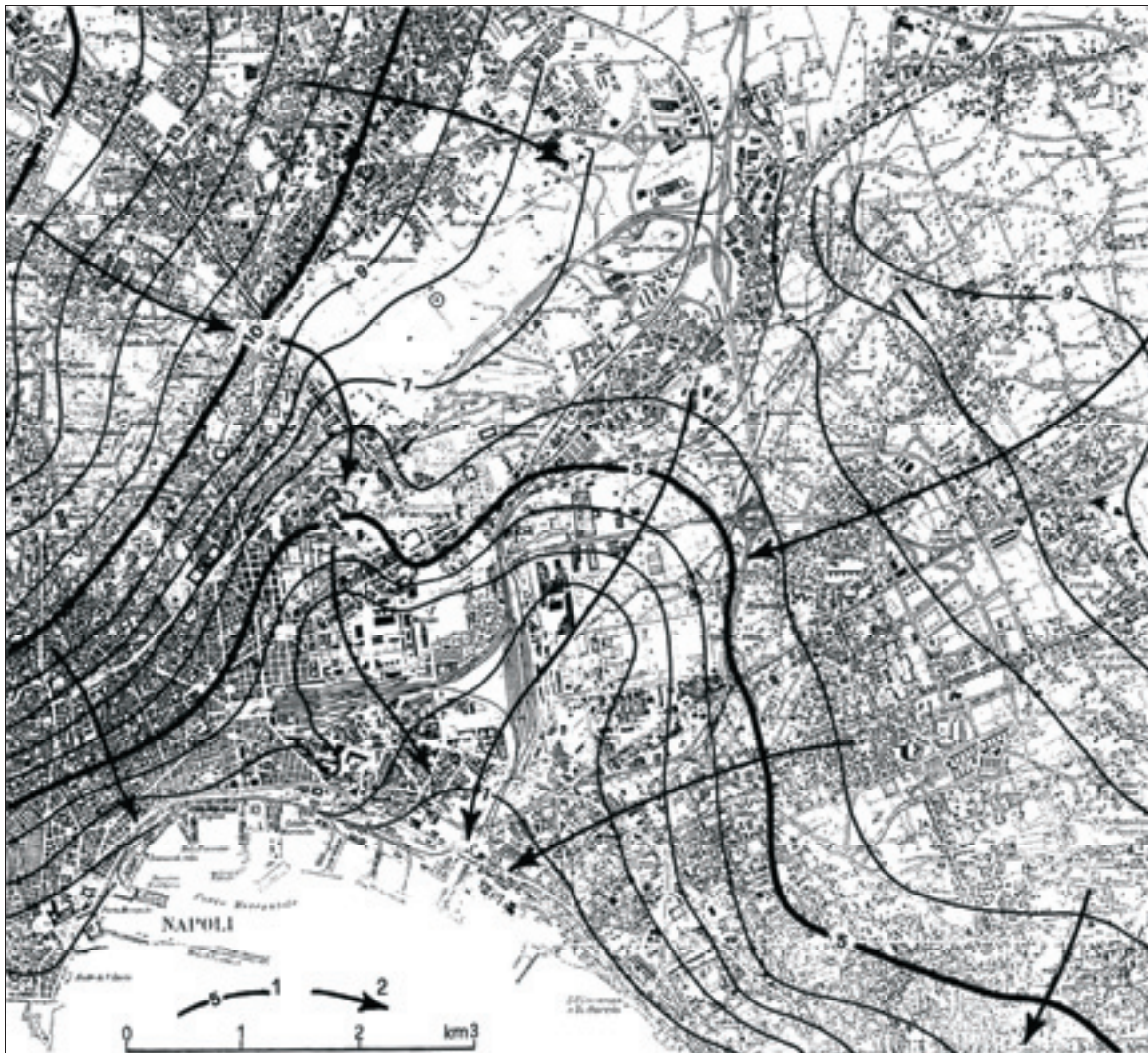
Figura 8 – Carta a curve isopiezometriche del centro urbano di Napoli: valori medi del 1992 (Comune di Napoli, 1994, modificata e integrata). Legenda: 1) Curve isopiezometriche e relativa quota in m s.l.m.; 2) Direttrici di flusso idrico sotterraneo.
