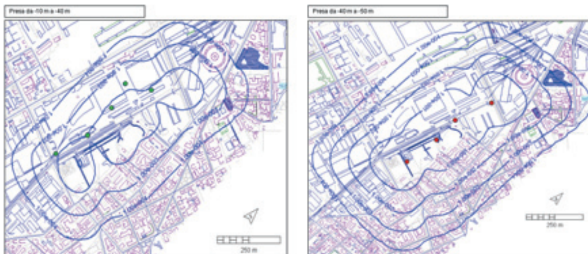
Figura 8. Previsione evoluzione trasporto calore in falda a 50 anni con pozzi presa (in verde) e resa (in rosso) a quote differenziate e in posizioni definite dal cliente.
