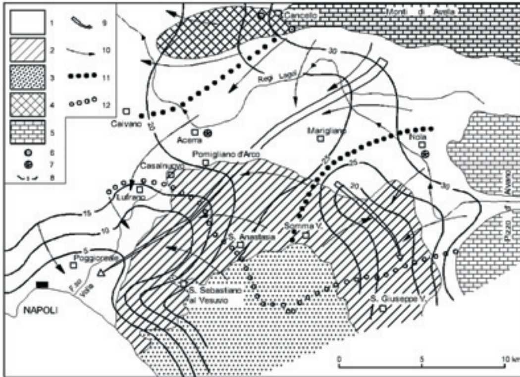
Figura 5 – Carta a curve isopiezometriche della piana ad Oriente di Napoli relativa al periodo 1978÷1979 (Celico, 1983, modificata e integrata). Legenda: 1) Depositi piroclastico-alluvionali; 2) Depositi piroclastici e lave; 3) Lave; 4) Depositi travertinosi; 5) Rocce carbonatiche; 6) Sorgenti principali; 7) Stazioni freaticmetriche dell'ex S.I.M.N. (Servizio Idrografico Mareografico Nazionale) indicate in figura 15; 8) Curve isopiezometriche e relativa quota in m s.l.m.; 9) Asse di drenaggio preferenziale; 10) Direttrici di flusso idrico sotterraneo; 11) Spartiacque sotterraneo; 12) Spartiacque superficiale.
