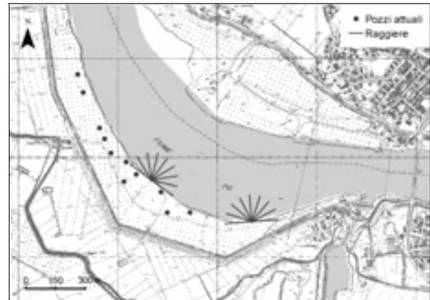
Figura 1 – Schema planimetrico dei pozzi a raggiera (in blu parte del campo pozzi esistente).
