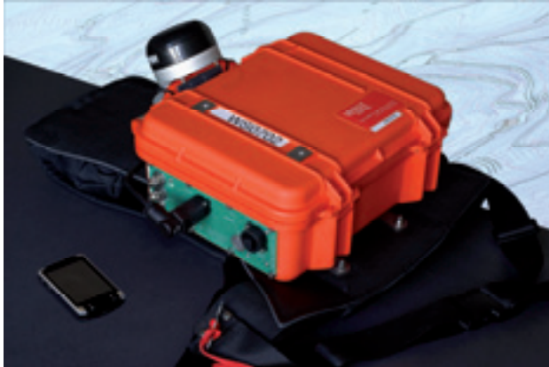
Figura 10. Lo strumento integrato per la misura di flussi diffusi. Figure 10. Integrated instrument for diffuse flux measurement.
