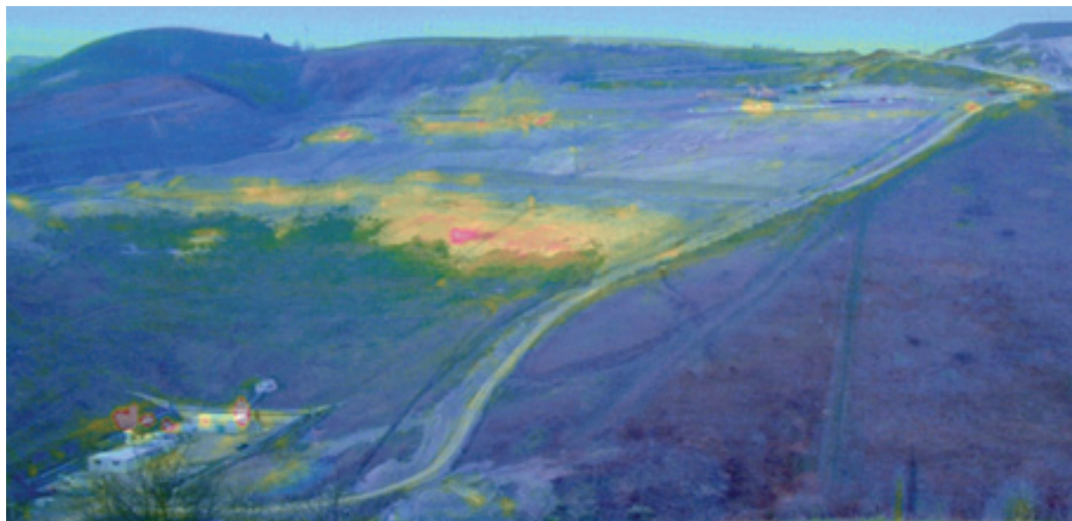
Figura 2. Mappa termografica della discarica di Legoli (Peccioli, Pisa). Figure 2. Thermographic map of Legoli landfill.
