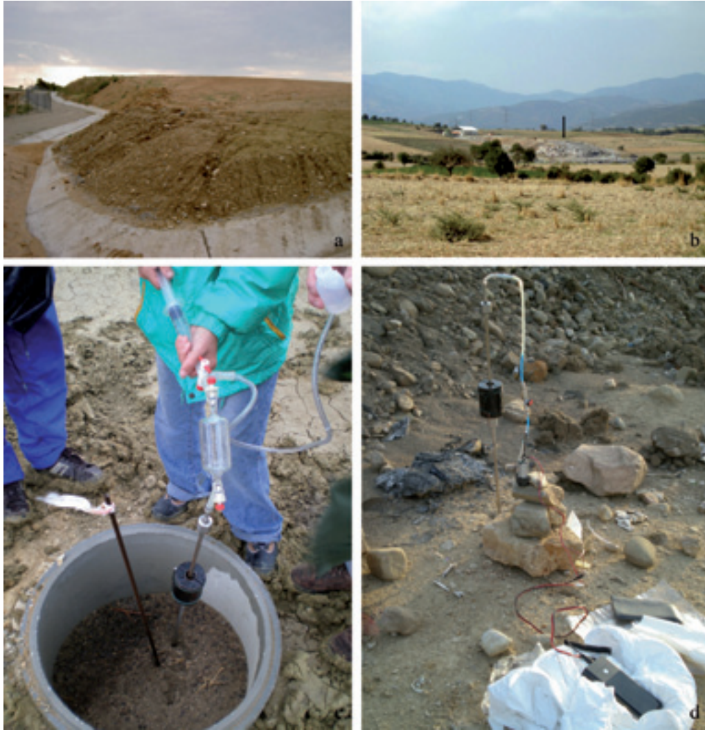
Figura 2. Foto delle discariche (inattiva e attiva) e relativi campionamenti di gas; a) stato attuale della vecchia discarica con copertura; b) discarica nuova; c) campionamento di biogas nei camini di degassamento della discarica inattiva; poiché entrambe le discariche non hanno un impianto di captazione del biogas, il campionamento è avvenuto direttamente dal corpo rifiuti attraverso l'introduzione nel terreno (a profondità variabile; 25-50 cm) di un fioretto e aspirazione manuale con siringa e by-pass; il biogas estratto è poi raccolto in ampolle o sacche sottovuoto; d) campionamento di biogas nella discarica attiva.
