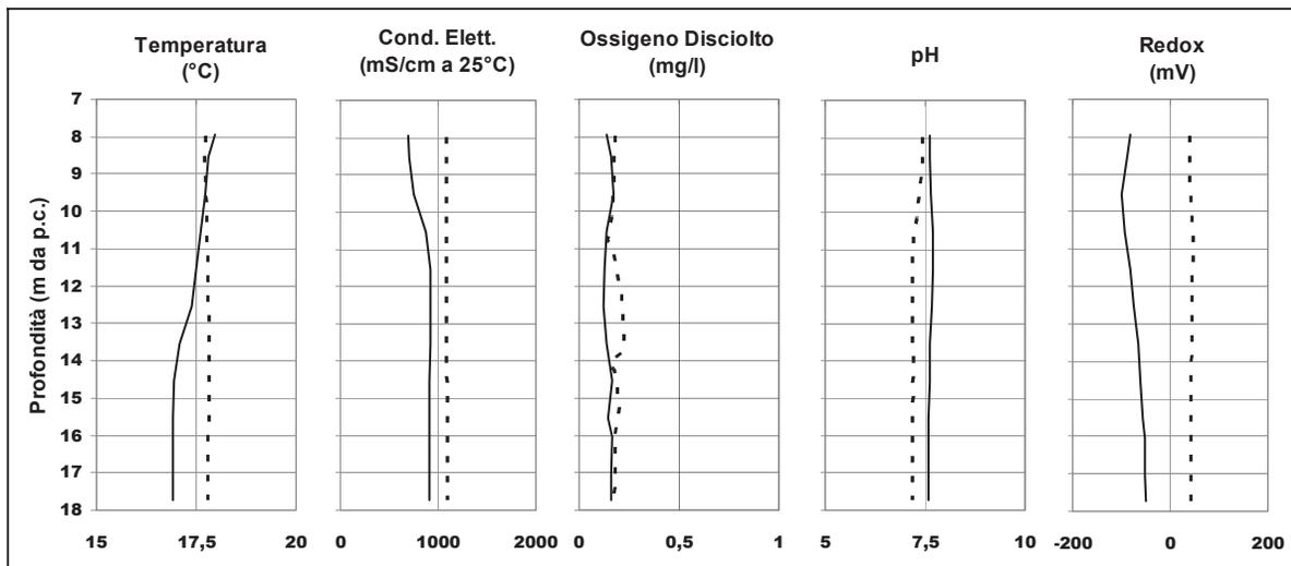
Figura 4. Tipici carotaggi multiparametrici rilevati nel pozzo. Con la linea tratteggiata, carotaggio effettuato nel periodo primaverile; con linea continua, carotaggio effettuato nel periodo invernale.
