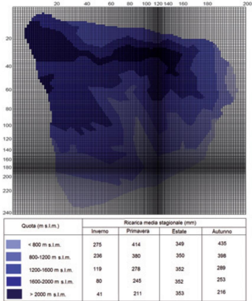
Figura 5. Griglia di discretizzazione del dominio. I colori evidenziano le diverse zone di ricarica, corrispondenti a diverse fasce altitudinali.
