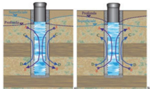
Figura 2 (Da Menegon et al., 2008) – Pozzo misto: a) flussi attraverso la tubazione e attraverso il dreno con gradiente diretto dalla falda superficiale alla falda profonda; b) flussi attraverso la tubazione e attraverso il dreno con gradiente dalla falda profonda alla falda superficiale.
