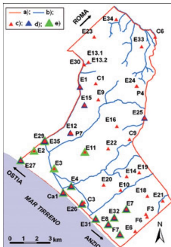
Figura 4 - Attuale rete di monitoraggio idrogeologico della Tenuta Presidenziale di Castelporziano; a) limite della Tenuta; b) reticolo idrografico; c) piezometri della rete di monitoraggio; d) piezometri con sonde automatiche; e) piezometri in cui sono rilevati log verticali dei parametri chimico-fisici delle acque.
