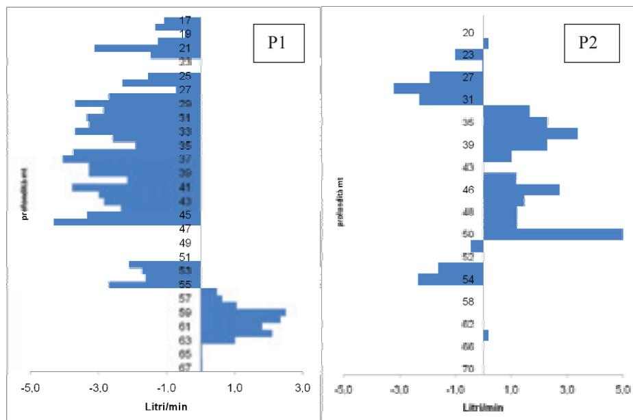
Figura 10 – Risultati del flowmeter test eseguito nei pozzi P1 e P2.
