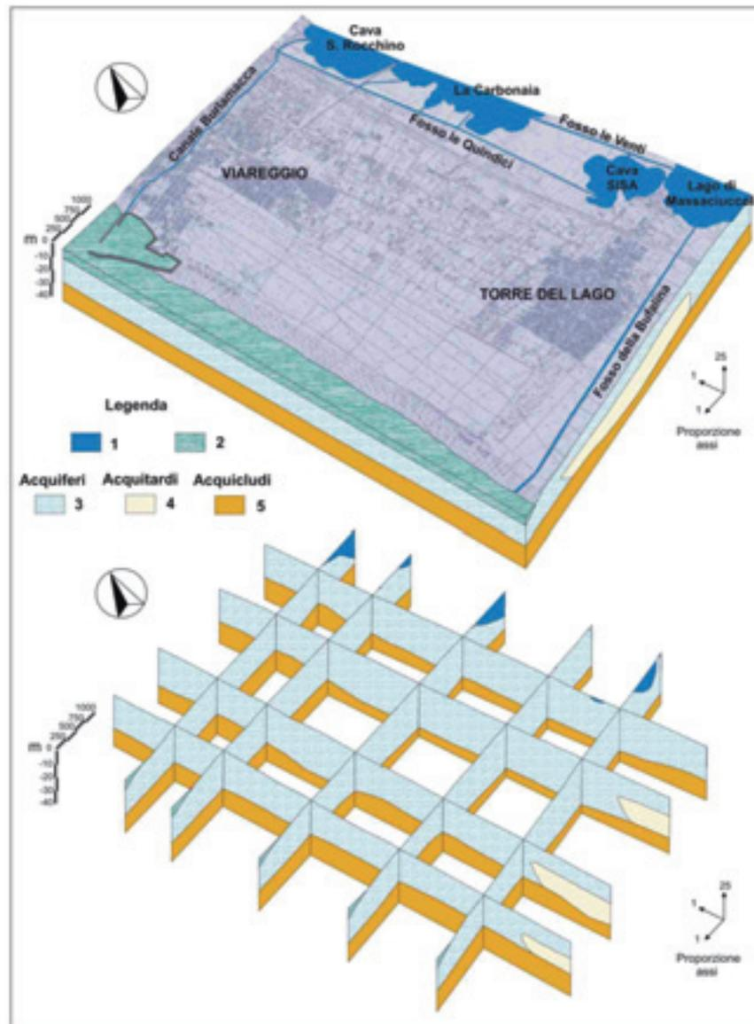
Figura 4 - Block-diagram dell'area di studio (sopra) e relativo fence-diagram (sotto). (1) acque superficiali; (2) acqua di mare; (3) sabbie e sabbie limose; (4) limi con locali intercalazioni torbose; (5) argille.
