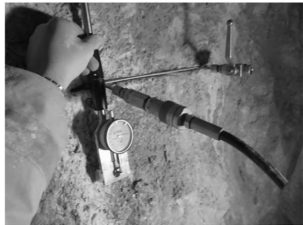
Figura 5 - Misura con deformometro
