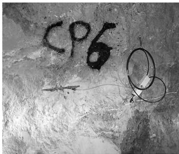
Figura 4 - a) Schema delle celle di pressione installate; b) Cella installata su un pilastro della cava "San Pietro-Pratonuovo" di Murisengo.
