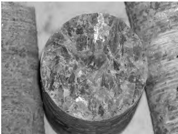
Figura 7 - Porzione di carota di gesso macrocristallino su cui sono state effettuate le analisi di laboratorio
