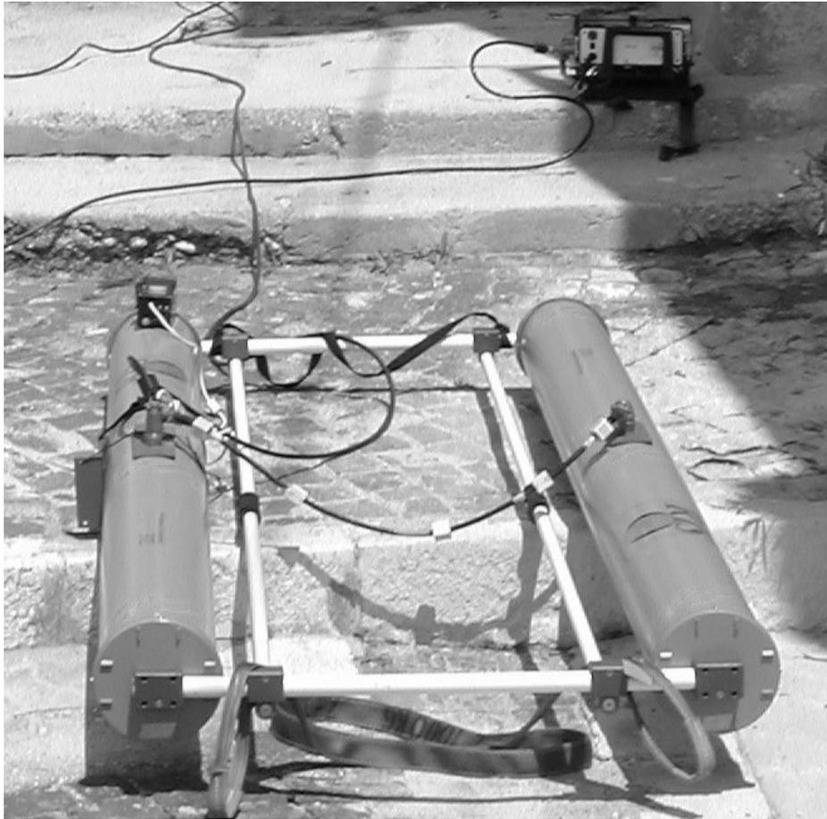
Figura 2. Il prototipo di antenna da 40 MHz, bistatica, non schermata
