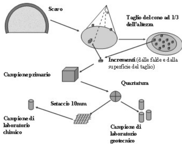
Fig. 3: Schema di formazione dei campioni per i laboratori nello scavo con TBM da roccia
