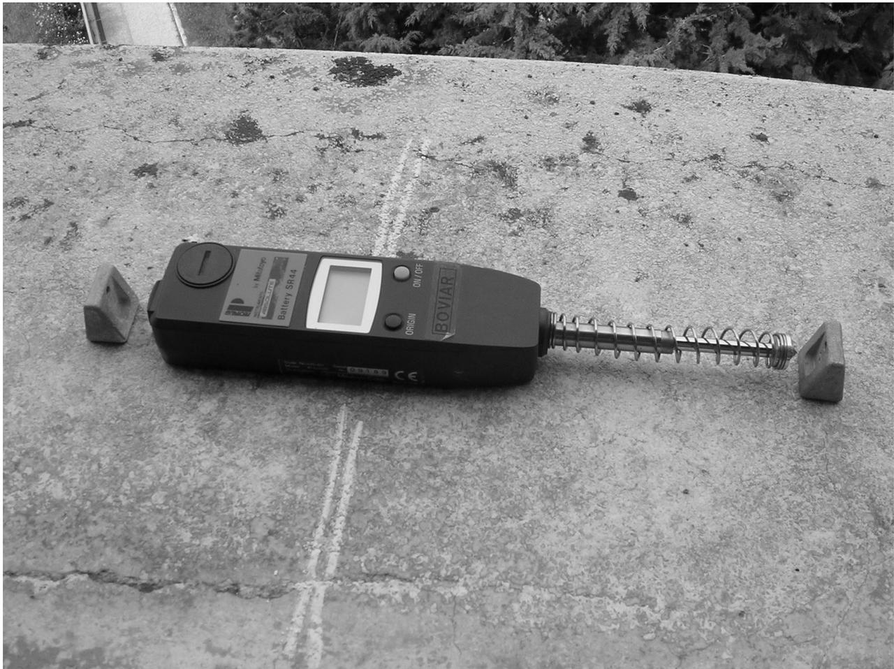
Fig. 3– Il fessurimetro impiegato per la misura del movimento dell'apertura delle discontinuità. La linea tracciata col gesso simula la frattura, mentre i 2 blocchetti di riscontro vengono fissati ai suoi lembi.
